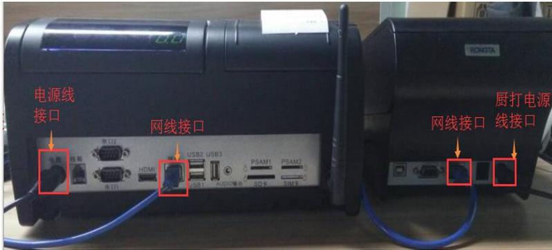
系统最多连接 8 台厨房打印机（网口、串口）。以网口连接为例，将终端与厨房打印机直连，或通过交换机进行分连。
