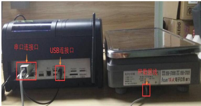
将终端与电子计价称（支持型号详见“外设列表”）连接。电子称需设置相应模式，如下：
