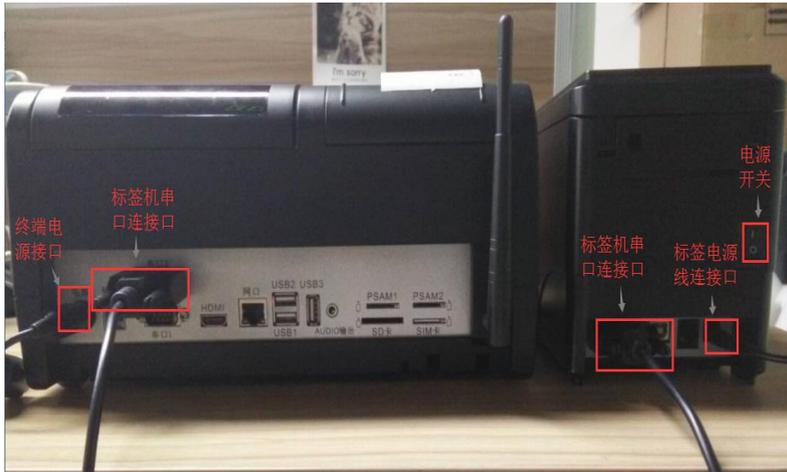
将终端与标签打印机（支持型号详见“外设列表”）使用串口连接。
