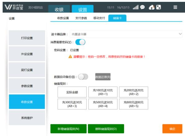
①读卡器品牌：选择读卡器品牌，系统支持储值卡类型包括 IC 卡（实体卡）、磁条卡（虚拟卡）。IC 卡读卡器支持型号详见外设列表。磁条卡读卡器为 U 口通用型读卡器。
